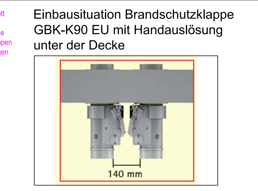
Einbausituation Brandschutzklappe GBK-K90 EU mit Handauslösung unter der Decke
